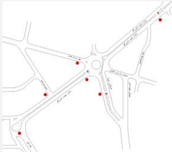
شکل 5: مبادی ورودی و خروجی شبکه مورد مطالعه جهت آمارگیری مبداء - مقصد با روش پلاک خوانی
